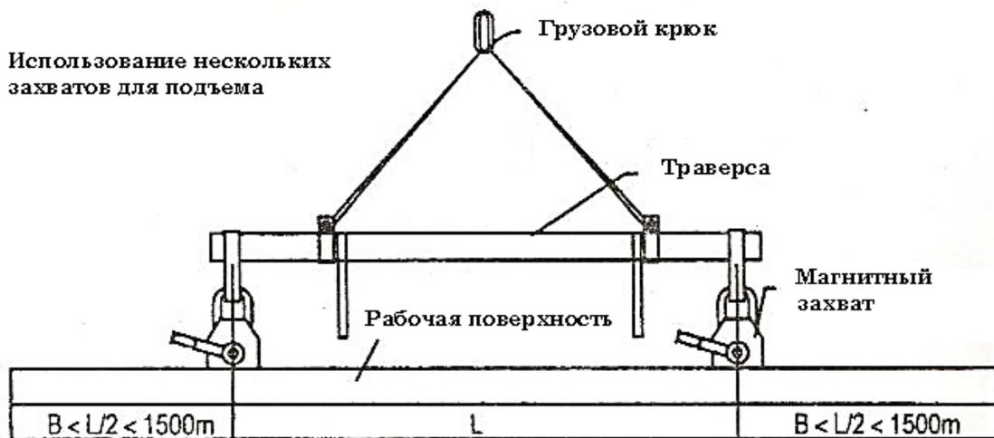
Иные схемы крепления не допустимы, а именно, запрещено использование захвата (захватов) при несовпадении центральной линии захвата и оси груза.
