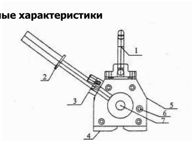
Рисунок 1. Сборочные детали магнитного захвата
